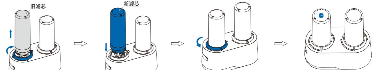
(1) 转动滤芯旋转盖,将把手对准机身解锁标识,取出旧滤芯。
