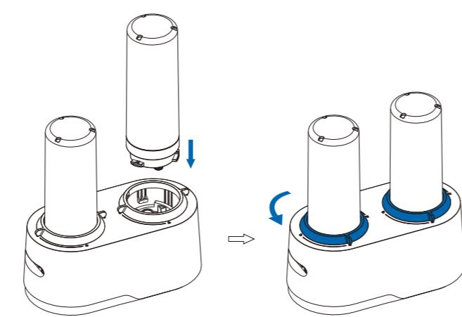
3/4.正确安装PCB及RO滤芯，锁紧滤芯旋转盖。
