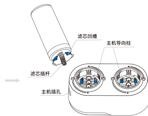
2.滤芯凹槽对准主机导向柱
