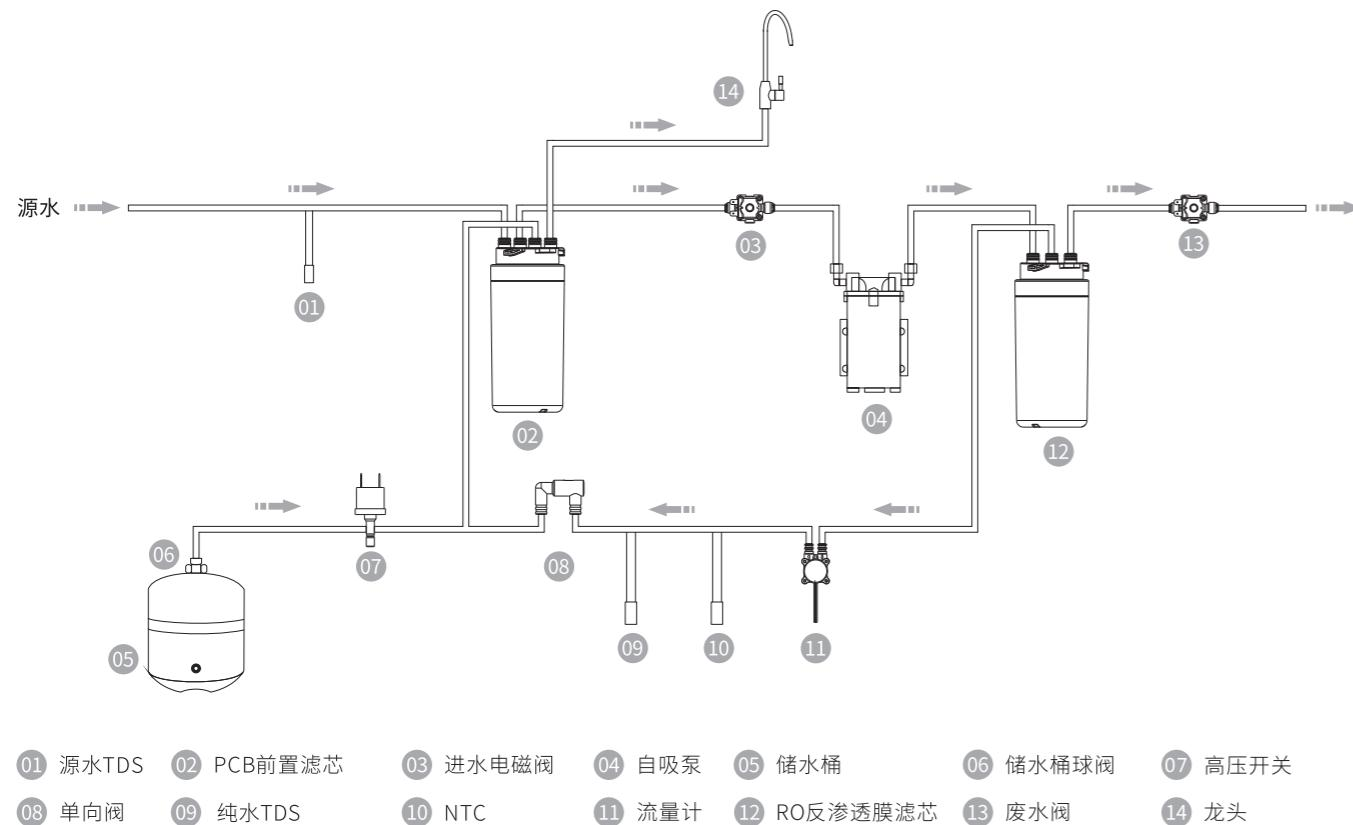
01 源水TDS 02 PCB前置滤芯 03 进水电磁阀 04 自吸泵 05 储水桶 06 储水桶球阀 07 高压开关
