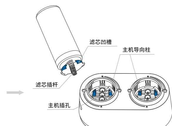
2.滤芯凹槽对准主机导向柱
