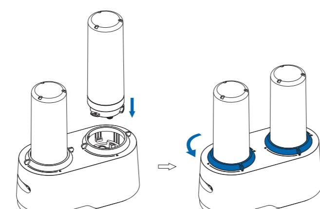
3/4.正确安装PCB及RO滤芯，锁紧滤芯旋转盖。
