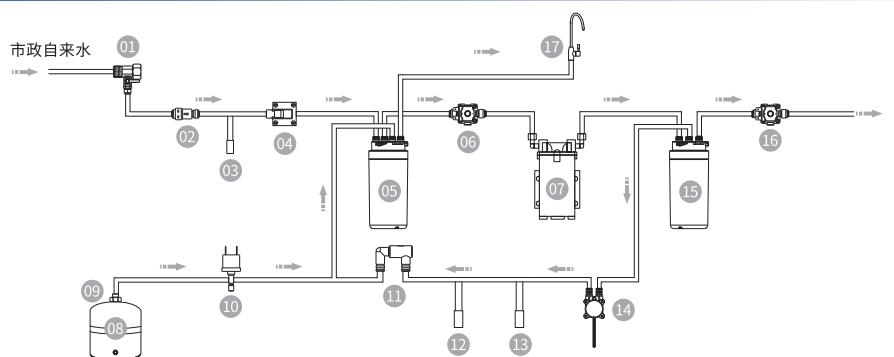
01 球阀三通 02 管式恒压阀 03 源水TDS 04 低压开关 05 PCB复合滤芯 06 进水电磁阀
